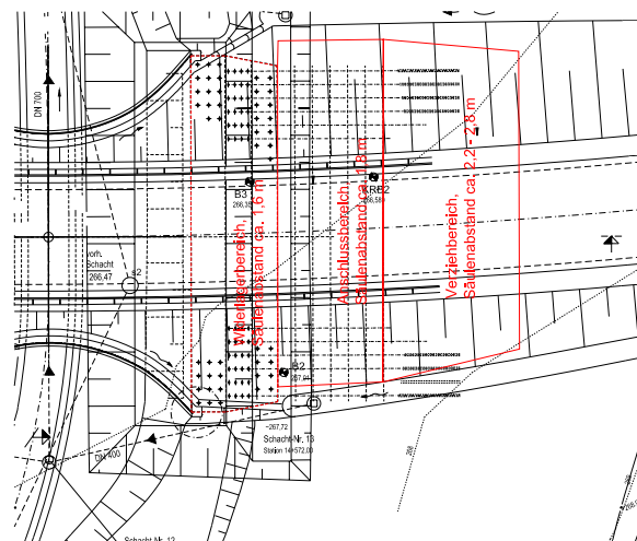
Bild 3: Prinzipielle Rasteranordnung der Untergrundverbesserung
